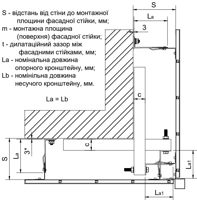
Влаштування фасадних стійок каркасу
