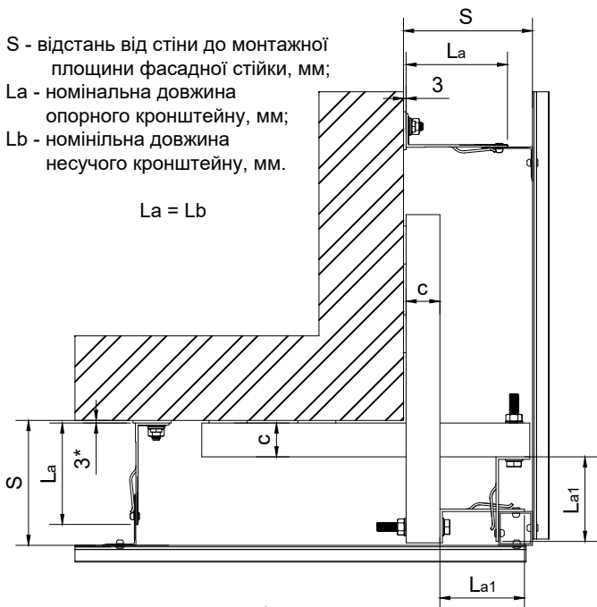
Влаштування фасадних стійок каркасу
